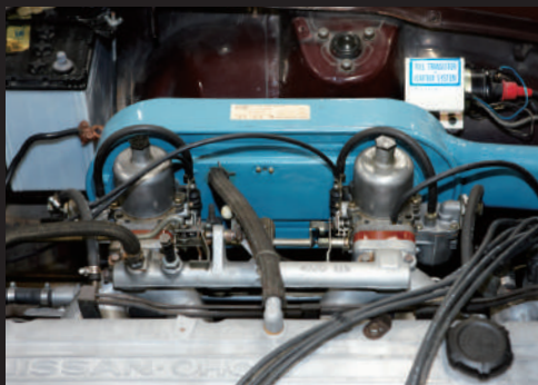
根據排氣量，化油器從38mm擴大至46mm，裝配了兩個。
