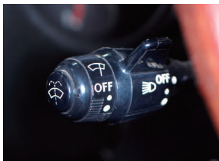
車燈、雨刷等開關等功能，為了操作方便，被集中在方向盤左側。
