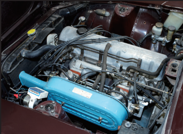
L24型引擎的進氣閥和排氣閥位於同一側。因此，其進氣歧管和排氣管也位於同一側。
